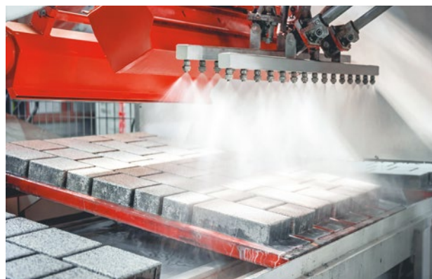
Установка «отмыва» фактурного слоя из крошки натурального камня
